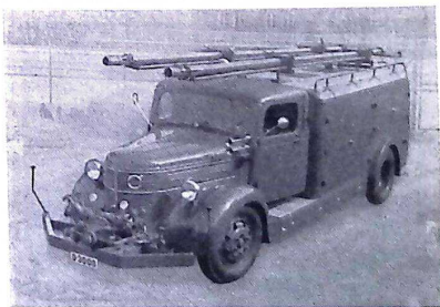
Bild 5. Skumbrandbil med bl a två teleskopskummaster.
