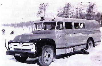
Bild 1. Brandbilarna är utformade som bussar med bilpumpen placerad inne i den stora personalhytten. Tryckkuttagen och sugstudsens sitter strax under dörren till personalhytten.
